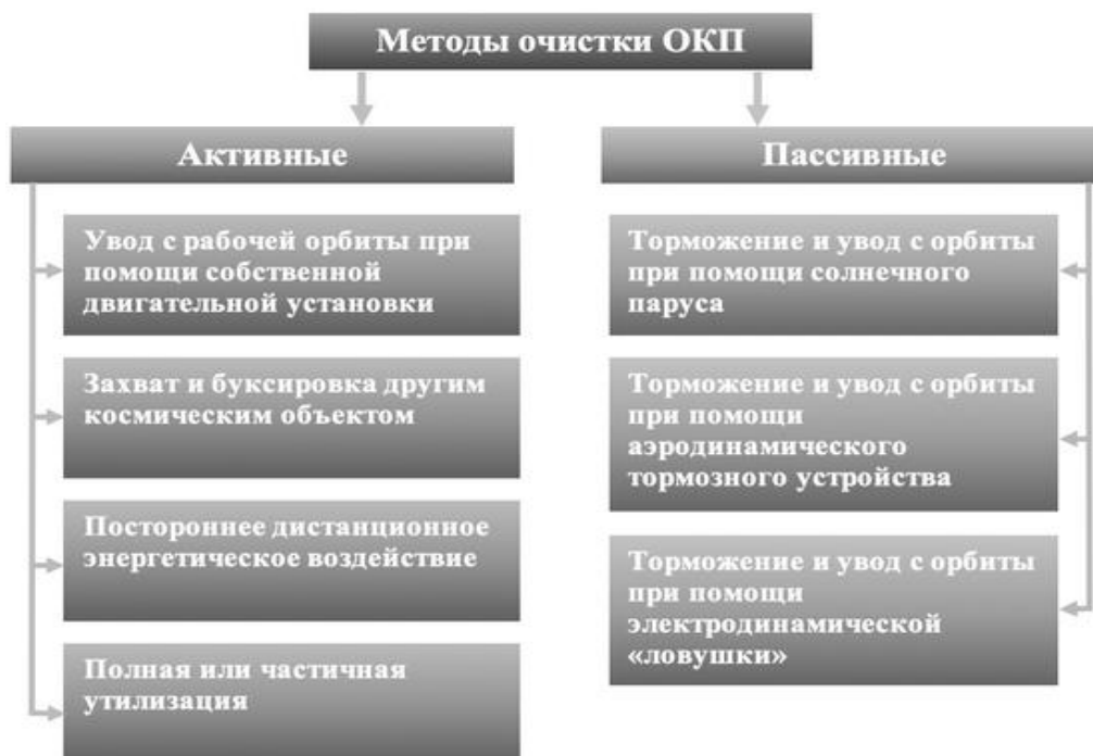
Рисунок 3 – Классификация методов очистки околоземного космического пространства от космического мусора
