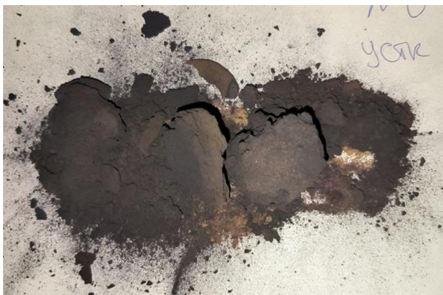
Рис. 2. Продукт металлизации при температуре 1100 °С
