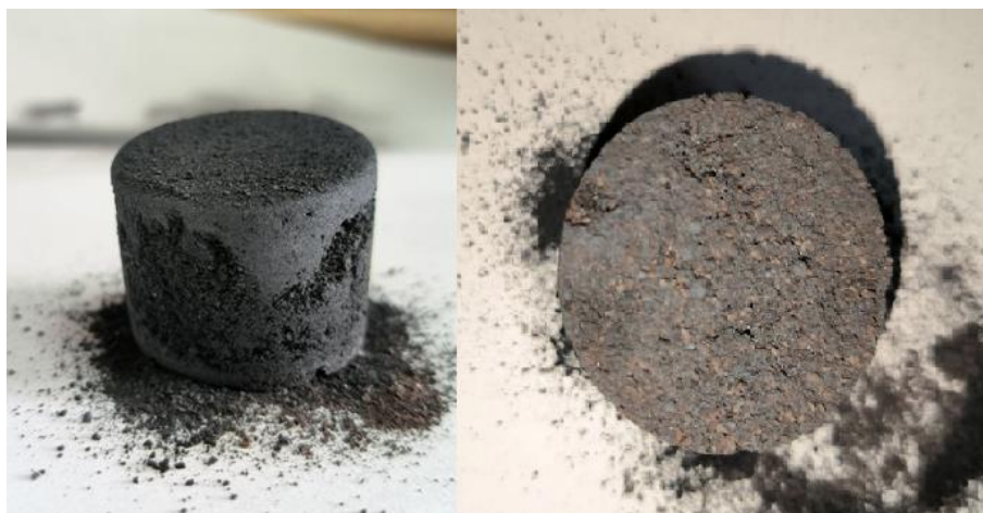
Рис. 1. Спеченный продукт металлизации
