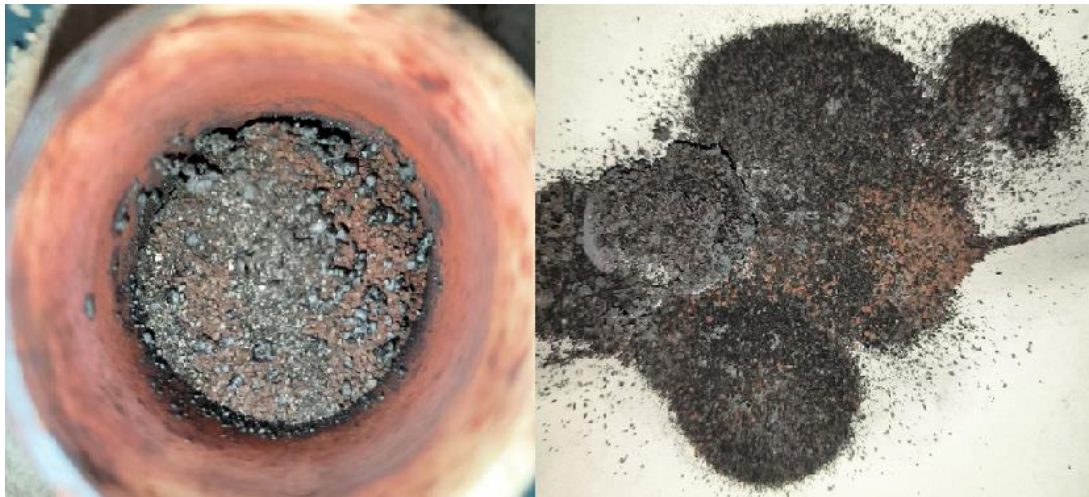
Рис. 3. Результат опыта М8 с каплями металла
