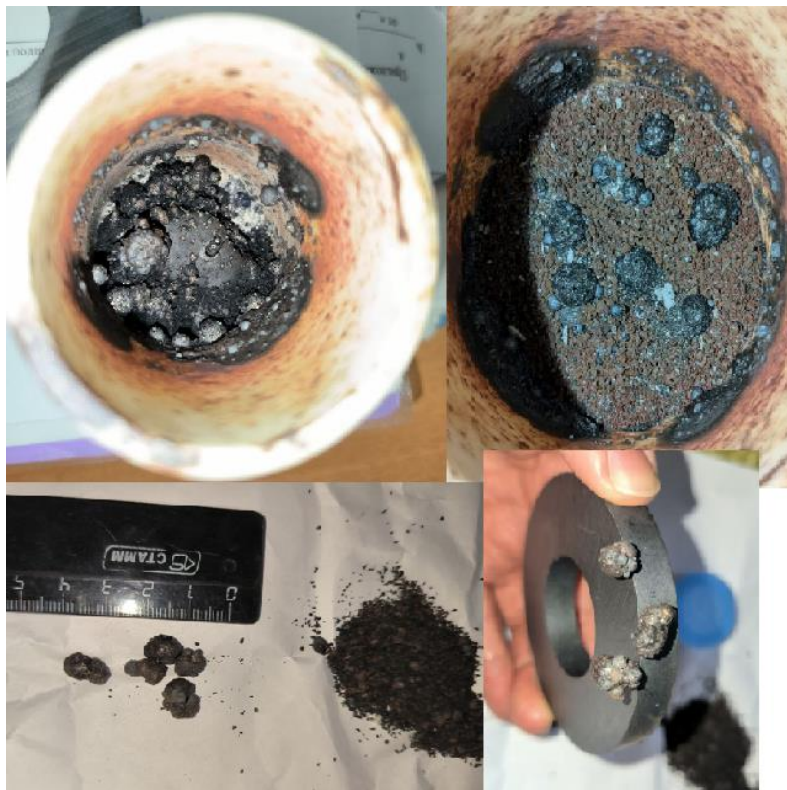
Рис. 4. Результат опыта М9 с каплями металла
