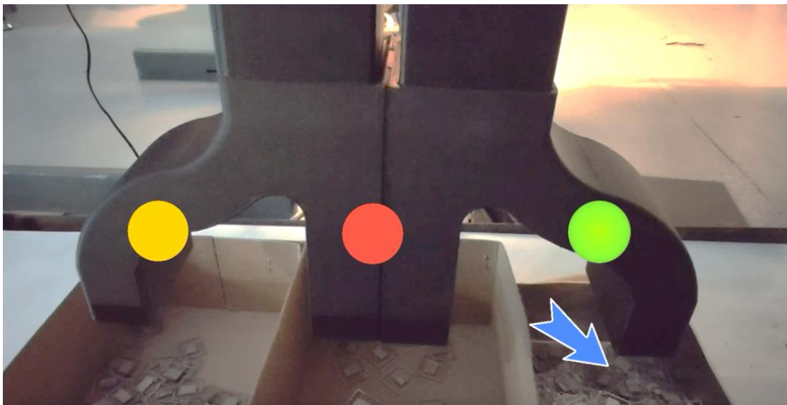
Рисунок 2. Отбраковщик АПАК с выделением ИЭТ с аномальными дефектами (желтым кружочком)
