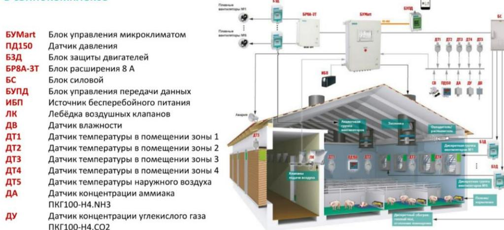
Рис.4 Схематичное изображение системы управления микроклиматом в свинарнике.
