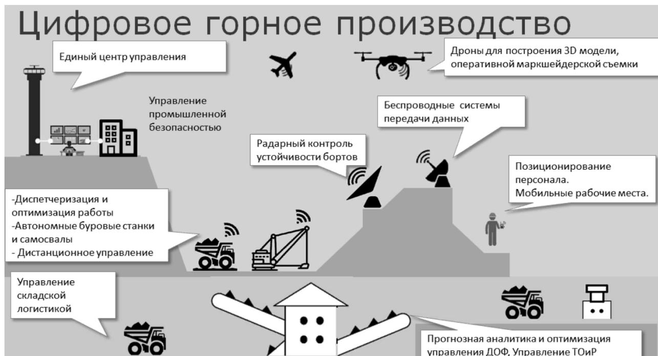
Рисунок 1 – Единое цифровое решение по цифровизации процессов добычи, транспортировки и отгрузки (компания ВГК)
