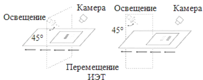
Рисунок 4 – Метод обнаружения дефектов с помощью оптического потока
