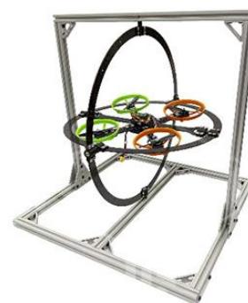
Рисунок 6 – Испытательный стенд для тестирования БПЛА
