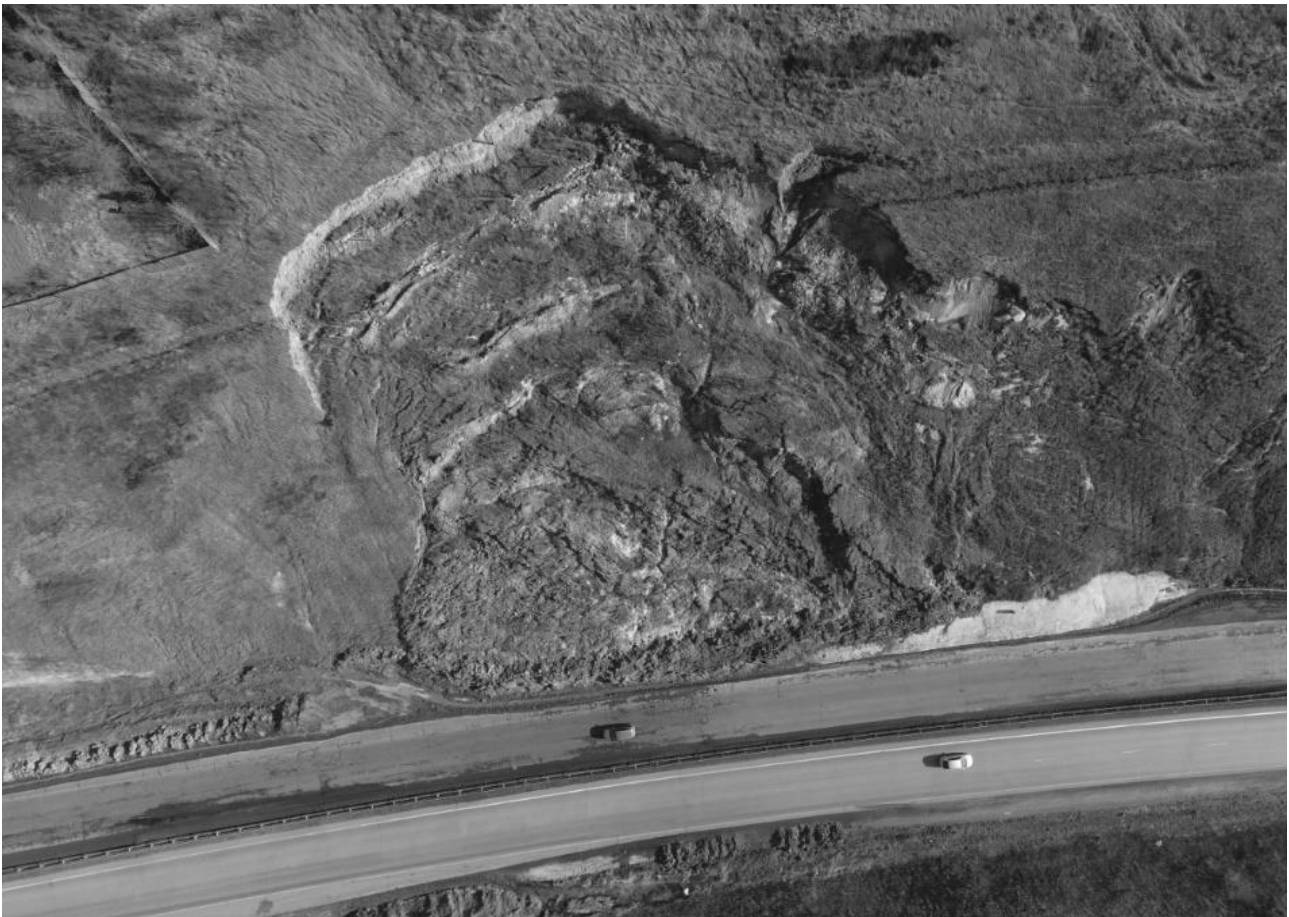
Рисунок 3 – Оползневые процессы перед Братским мостом
