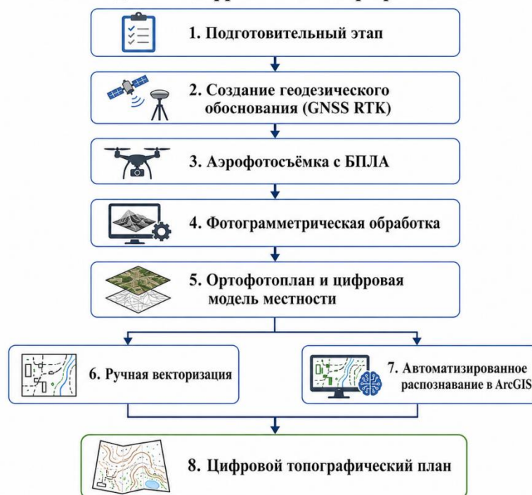
Рисунок 1 – Схема создания цифрового топографического плана
