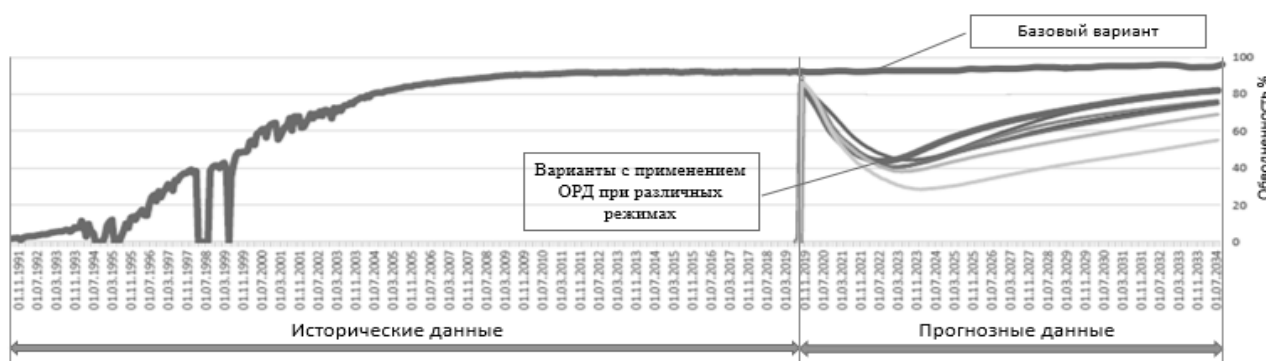
Рисунок 2 – Результаты расчета обводненности по базовому варианту и с применением оборудования для ОРД
