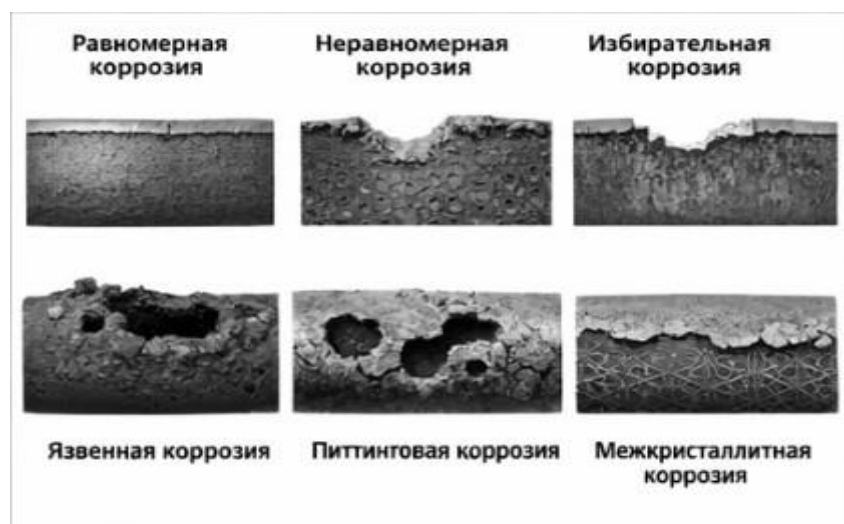
Рис. 1. Основные типы коррозионного разрушения металла
