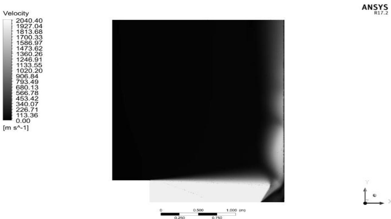
Рисунок 3 – Поле скоростей при  $h = 1800$  мм и  $n = 1,0$  в случае плоской преграды
