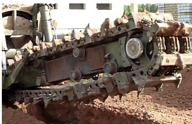
Рис. 4 Рабочий орган с цепями наружного зацепления
