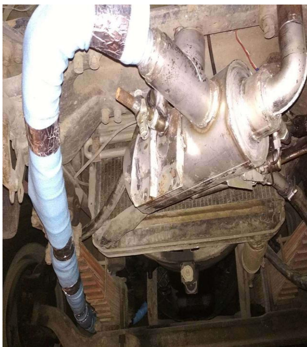
Рисунок 3. Усовершенствованный предпусковой подогреватель на автомобиле.
