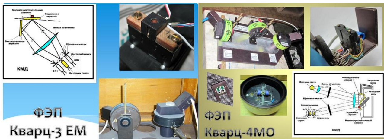
Рисунок 3. Схемы КМД и фотоэлектрических преобразователей (ФЭП) различных моделей кварцевых магнитометров серии «Кварц-3 и 4» [1, 7, 9].
