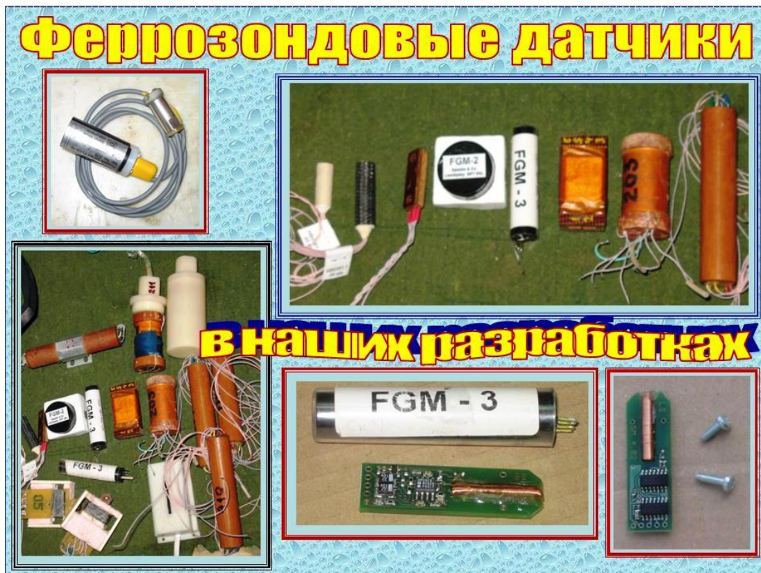
Рис.3. Отечественные и зарубежные ФД различного типа, применяемые для разработки и создания современных ФМ.
