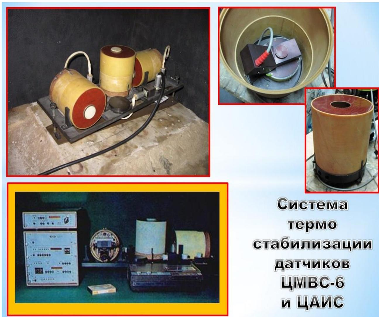
Рис.2. Общий вид ЦМВС и системы термостабилизации КМД, которые установлены на ЮП.
