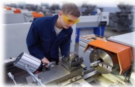
Рисунок 3. Обработка заготовки на токарном станке согласно размерам на чертеже в мастерской колледжа
