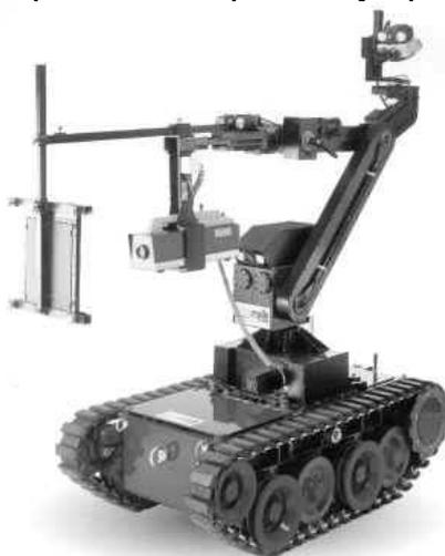
Рис. 6. Портативная рентгеновская аппаратура для обследования подозрительных объектов, установленная на мобильном роботе MV4
