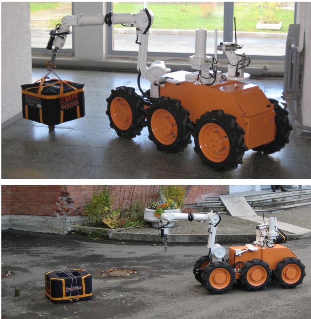
Рис. 1. Локализация взрывоопасного объекта мобильным роботом РТК-05
