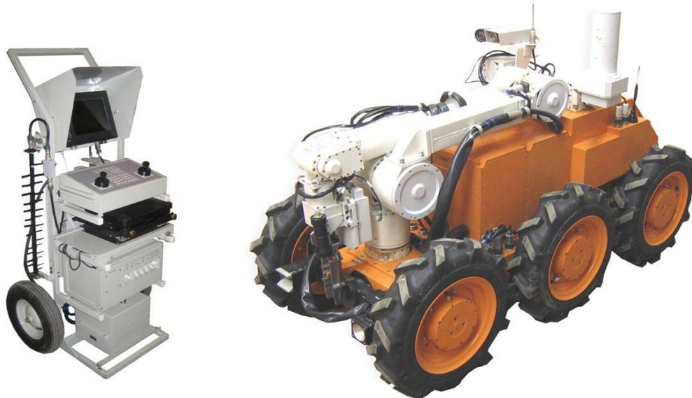
Рис. 2. МРК радиационной и химической разведки РТК-05
