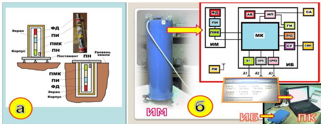
Рис. 2. Общий вид двух вариантов конструкции ИМ: настольный вариант для работы в МО и экспедиционный вариант (а) и функциональная схема МВС с регистрацией данных на ПК (б).
