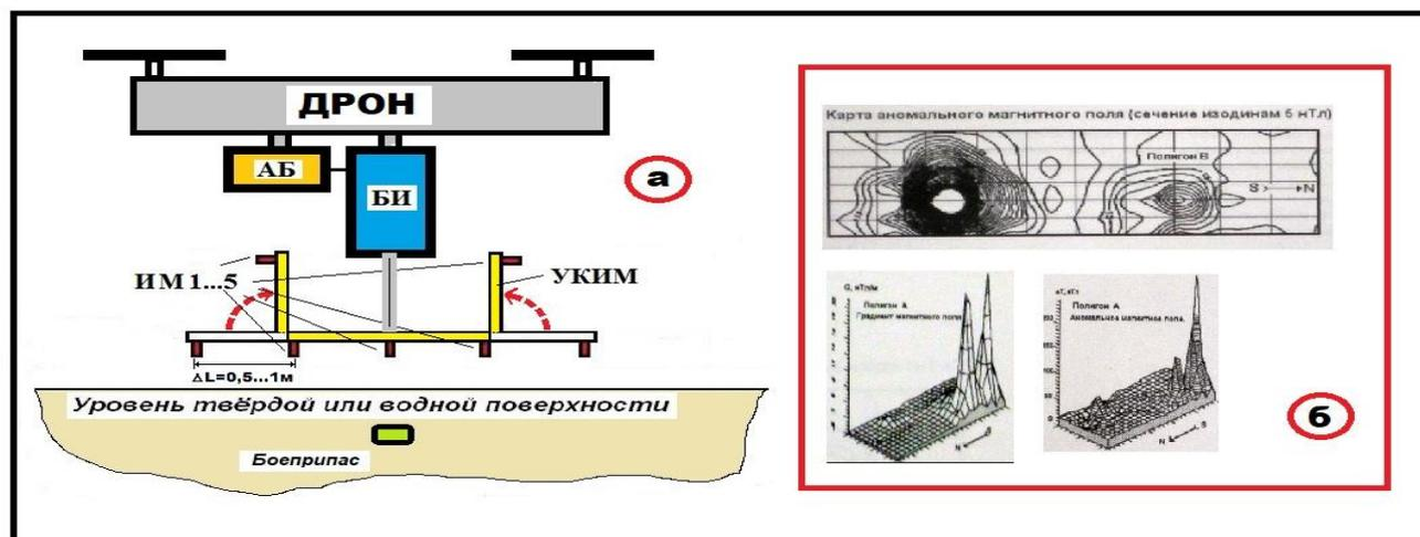
Рис.7. Конструкция многоканального магнитометра-градиентометра для установки на низколетающих дронах разных конструкций (а) и пример проведения поисковых работ при обнаружении магнитных объектов (б).
