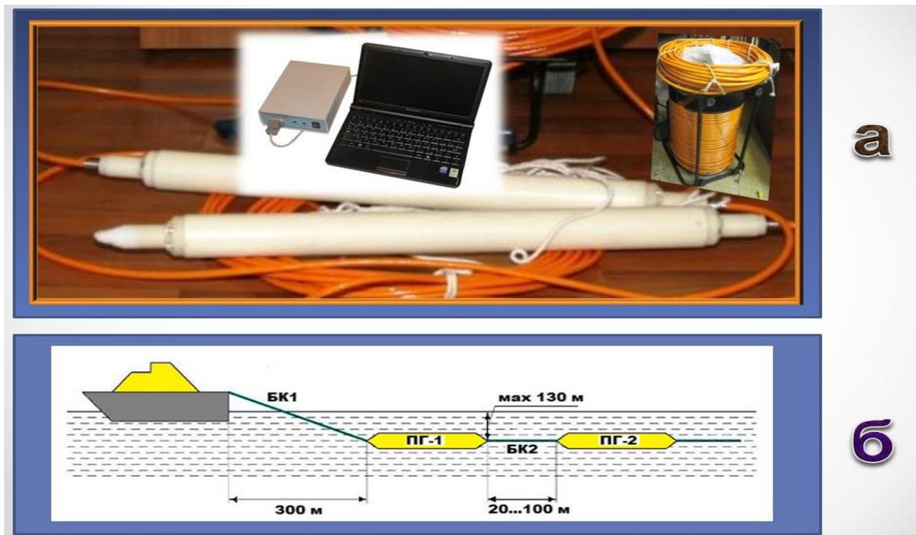
Рис. 4. Общий вид набортной и буксируемой частей МКГ (а) и схема буксировки прибора (б).
