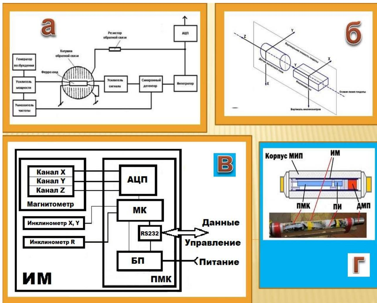
Рис.1. Блок-схема одноканального феррозондового МИП (а), схема расположения ФД и ЦИ (б), функциональная схема ИМ (в) и конструкция ИМ (г).
