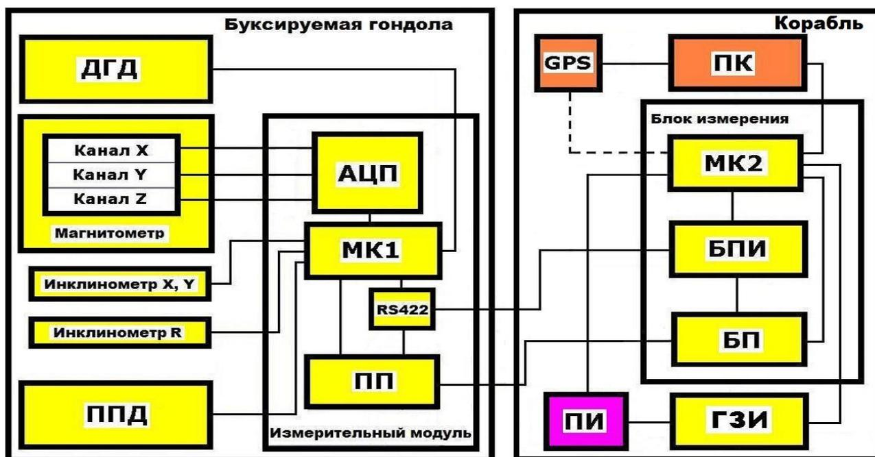
Рис.5. Структурная схема устройства для реализации измерения горизонтального градиента МПЗ в водной среде.
