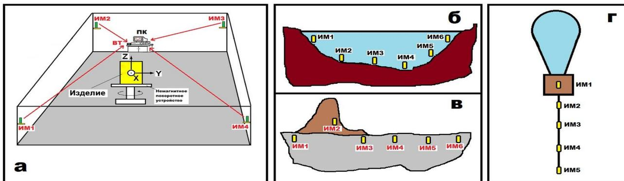
Рис.6. Схемы проведения исследований с применением ИМ: по изучению ММ изделия (а) и проведение многоканальных градиентометрических измерений в водной среде (б), на суше (в) и в воздухе (г).
