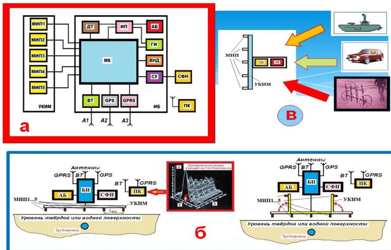
Рис.3. Функциональная схема прибора (а), схема расположения основных функциональных узлов прибора при проведении работ по измерению ГГ и ВГ (б) и возможные варианты применения прибора (в).
